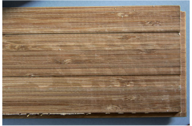
Zdj. 8. Spodnia strona deszczutki z bambusa ze śladami całkowicie odspojonego kleju.
