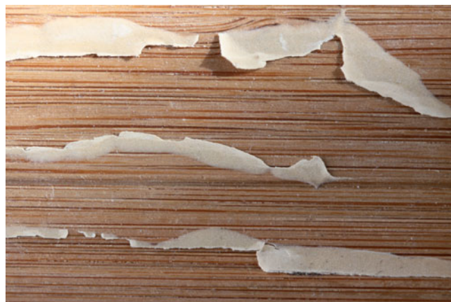
Zdj. 2. Spodnia strona deszczułki bambusowej z odpajającym się klejem.
