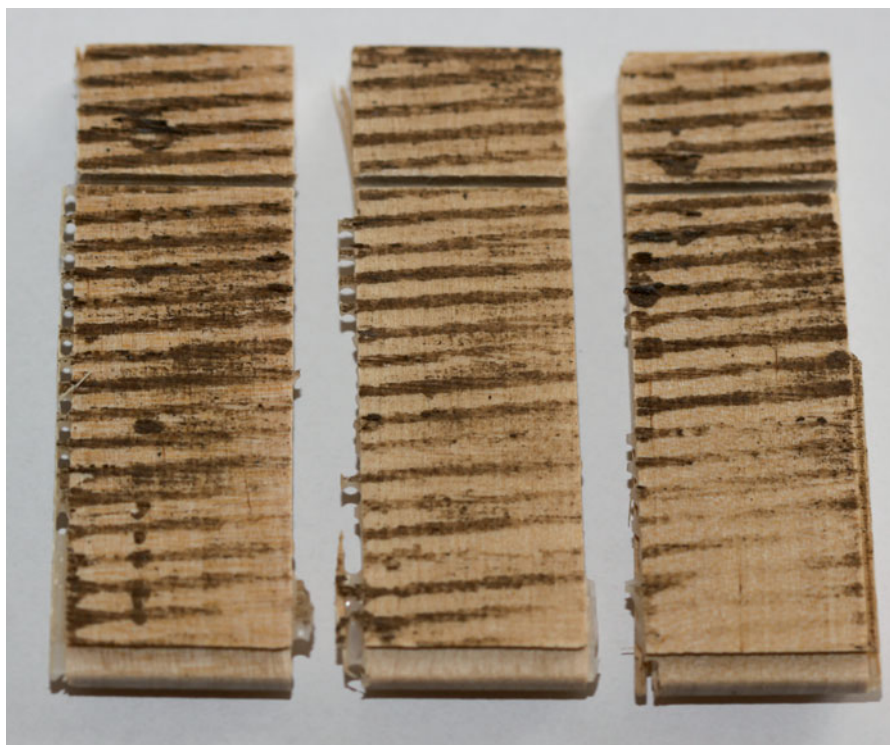
Zerwane lamelki parkietu dwuwarstwowego.
