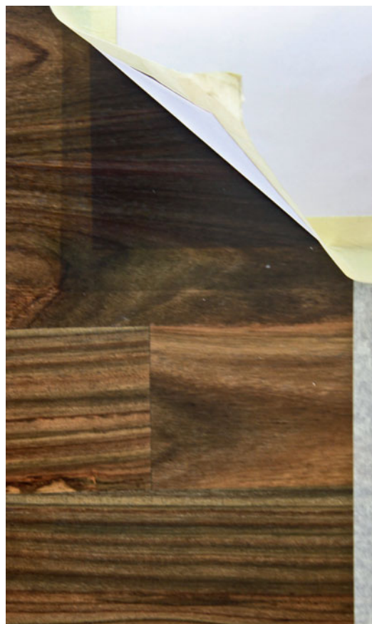
Zdj. 4. Naróżnik części pokrytej alkoholowym lakierem podkładowym, widoczna część zasłonięta na czas próby.
