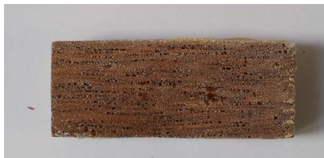
Zdj. 6. Spodnia strona zerwanego klocka - klej poliuretanowy, dwuskładnikowy.
