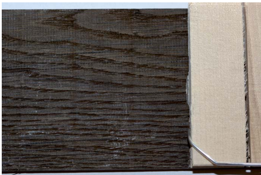
Spodnia strona warstwy użytkowej parkietu dwuwarstwowego po zerwaniu lamelki.
