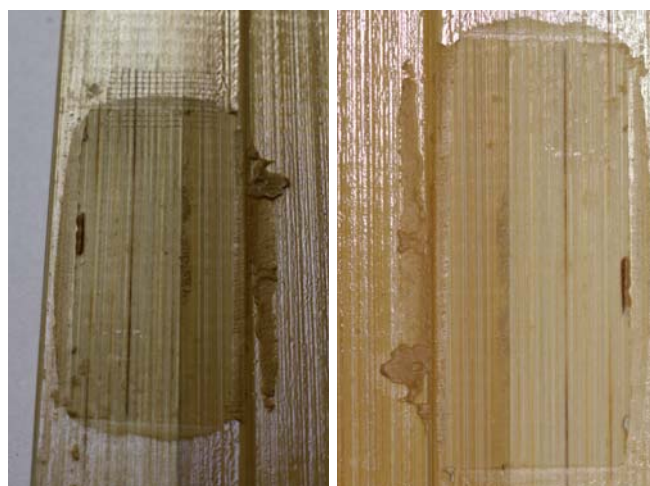
Zdj. 7. Powierzchnia po zerwaniu klocka - klej poliuretanowo-epoksydowy, dwuskładnikowy.
