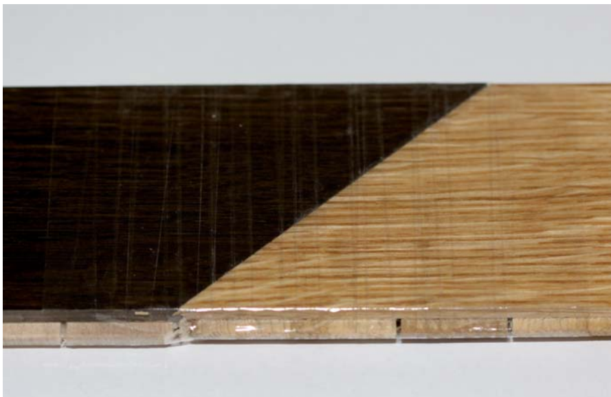
Kontaktowy test zawartości amoniaku resztkowego.
