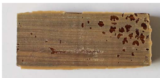
Zdj. 8. Spodnia strona zerwanego klocka - klej poliuretanowo-epoksydowy, dwuskładnikowy.
