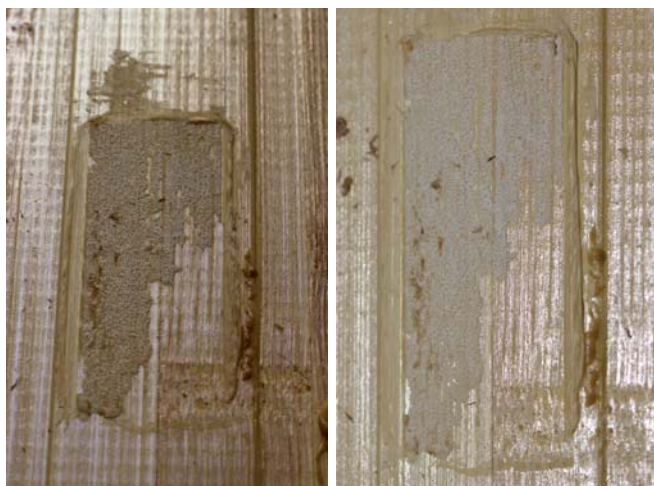
Zdj. 3. Powierzchnia po zerwaniu klocka - klej rozpuszczalnikowy.
