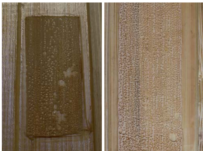
Zdj. 9. Powierzchnia po zerwaniu klocka - klej poliuretanowy, jednoskładnikowy.
