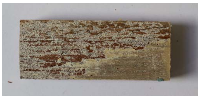
Zdj. 4. Spodnia strona zerwanego klocka - klej rozpuszczalnikowy.
