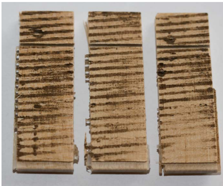
Zerwane lamelki parkietu dwuwarstwowego.
