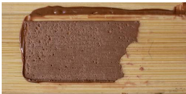
Zdj. 11. Powierzchnia po zerwaniu kleju MS-polimerowego, fragment oczyszczony.
