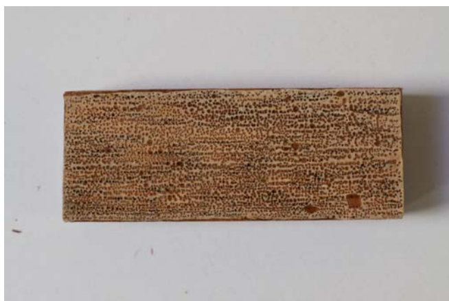
Zdj. 10. Spodnia strona zerwanego klocka - klej poliuretanowy, jednoskładnikowy.
