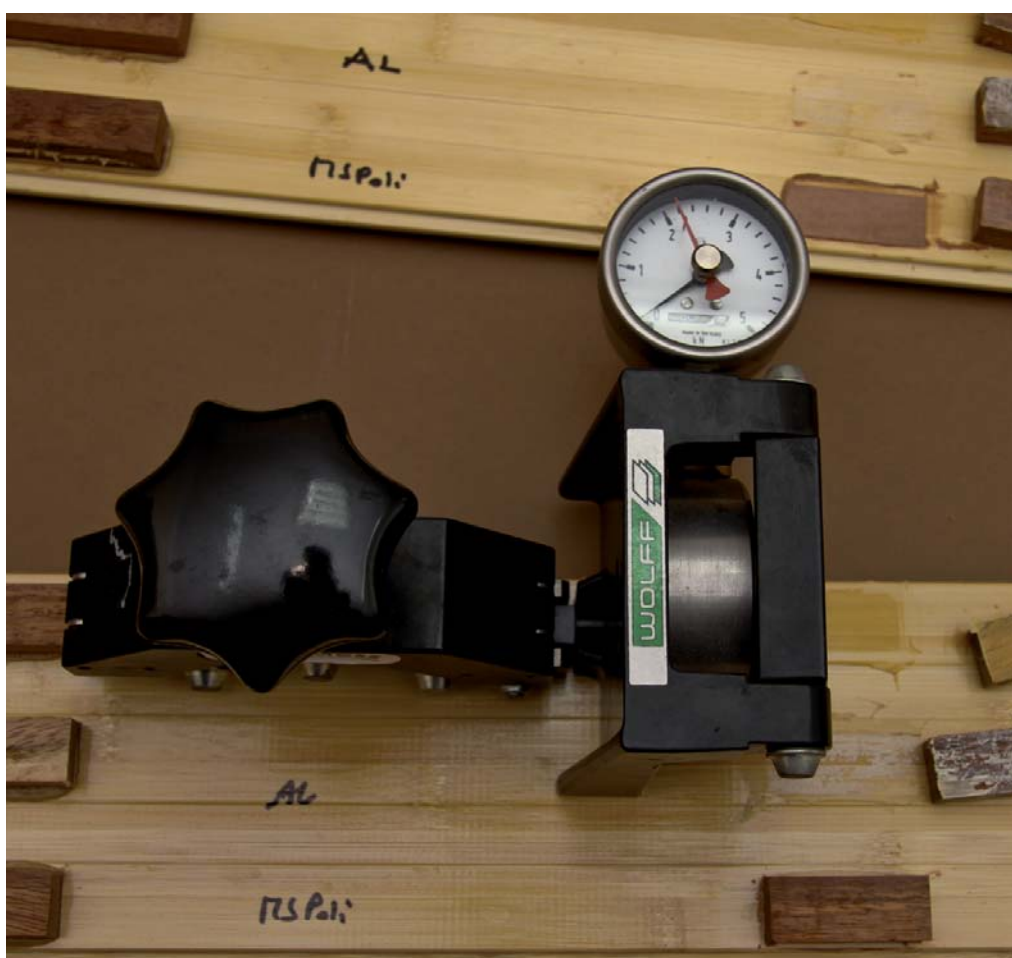
Zdj. 2. Klocki zerwane urządzeniem Pressomess.
