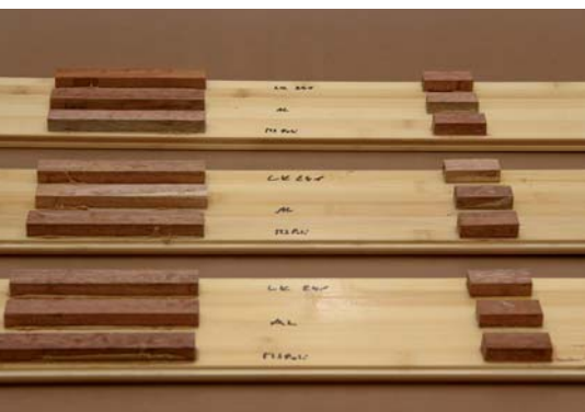
Zdj. 1. Deszczułki z przyklejonymi klockami oporowymi i testowymi
